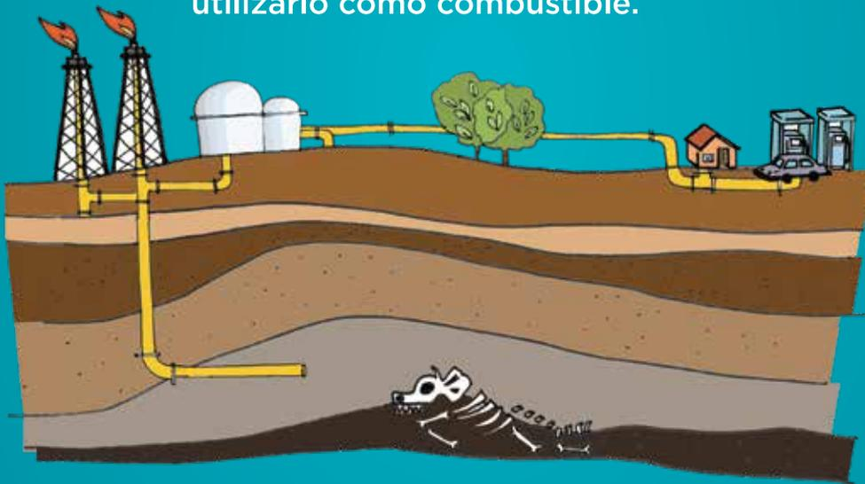
Luego de un tratamiento de purificación, en donde se separa el metano de los demás componentes, un sistema de gasoductos, ramales y redes lo transporta hasta la puerta de nuestras casas para que podamos utilizarlo.
